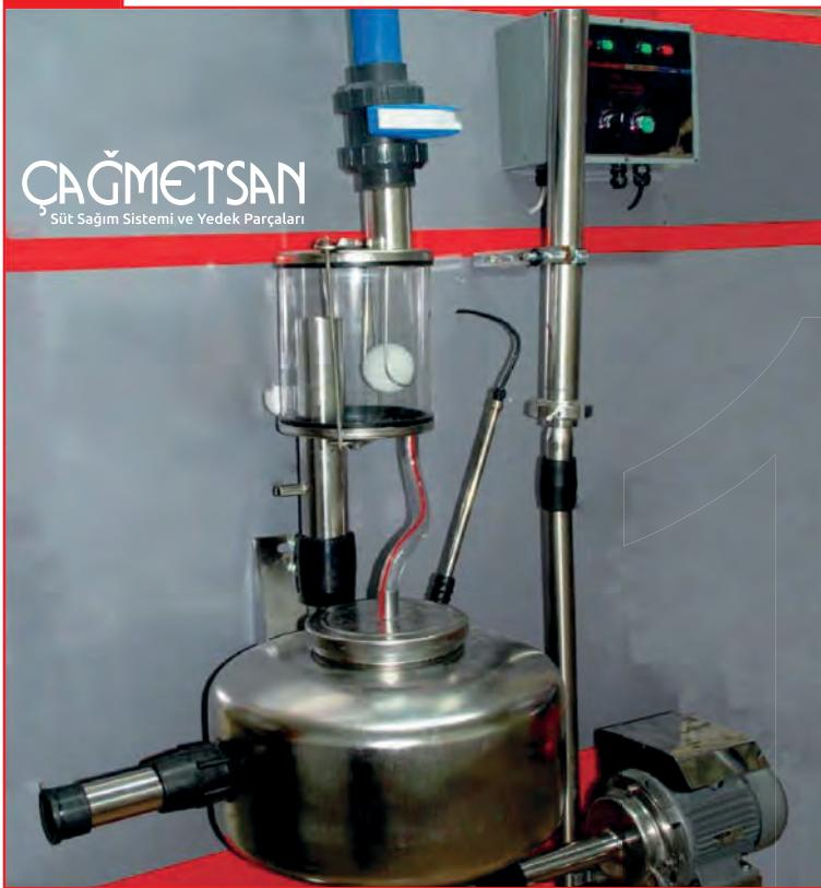
Aktarma Pompası Kontrol Panosu - Transfer Pump Control Box
