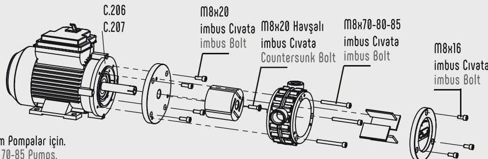
Ürün Teknik Detayları - 70-85mm Pompalar için.
