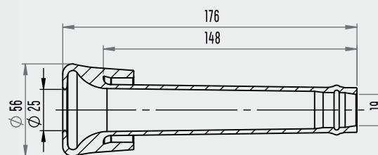
Kısa Süt Lastikleri Gıda Uygun Kauçuk hamaddeden , iklimsel koşullar dikkate alınarak, Steril olarak üretilmektedir. Kısa tip memelik lastikleri Süt Gözleme camları ile Paslanmaz Kılıflara monte edilmektedir. Sağım anında sütün görünmesi için tercih sebebidir.
